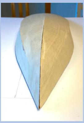
Wie beim Original verstärkte ich die Stoßkanten der Planken sowie die Verbindungen von Rumpf und Spanten mit einlaminierten leichten Glasfasermatten (50g/qm) und versiegelte die gesamte Rumpfschale mit Ausnahme des Cockpitbodens innen mit Epoxy. Es folgte der Einbau der restlichen Spanten, des Decksbalkens sowie der Cockpitwände.
