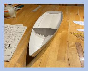
Nun ging es ans eigentliche Modell. Für Rumpf und Deck wählte ich 0,8 mm starkes Birkensperrholz, das man in Platten der Größe 60x30 cm kaufen und somit den gesamten Rumpf aus einem Stück ausschneiden kann. Für die Spanten kam 3 mm dickes Flugzeugsperrholz zum Einsatz.
