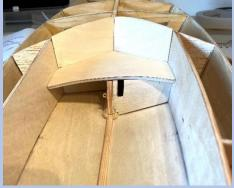
Dann stand schon die Hochzeit von Rumpf und Deck an, welches ich zum besseren Verkleben (mit 5 min Epoxy) in drei Teile geschnitten hatte. Vor dem Aufkleben des Decks erhielt der Rumpf eine Umrandung aus 3x2 mm Kieferleisten und die Cockpitspanten wurden leicht unterfüttert, um wie beim Original etwas abgerundete Seitendecks zu ermöglichen. Mit fertig verschliffenem Rumpf und Deck sah das Ganze nun langsam wie ein echter Seggerling aus.
