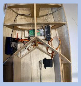
Die RC-Anlage wurde dann wieder ausgebaut und es ging weiter mit der Konstruktion des Schwertkastens. Um das Modell auch als Standmodell nutzen zu können, erhielt der Schwertkasten eine maßstabsgerechte Größe und wurde vor dem Zusammenbau innen lackiert und mit einem Loch zur späteren Fixierung des Kiels versehen. Vor dem Einbau erhielt der Rumpf innen eine Kielleiste aus 4x2 mm Kiefer, die im Bereich des Schwertkasten geteilt wurde. Dort wurde dann der Rumpf vorsichtig aufgefeilt.
