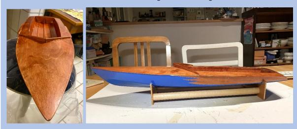
Nach kompletter Lackierung konnten nun die ersten Gewichtstests auf der Waage sowie in der Badewanne stattfinden. Der Rumpf kam auf rd. 250 g ohne und 350 g mit Fernsteueranlage. Zusammen mit einem Bleigewicht von 370 g zur Simulation des Kiels ergab sich eine passable Wasserlinie, die in etwa derjenigen eines originalen Seggerlings samt Besatzung entspricht.
